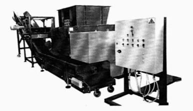
**R12** Раздробяване на текстилни отпадъци със специализирана ножова мелница 55 kW с цел достигане на 50 - 100 мм фракция и по-добро хомогенизиране на крайния продукт при последващо смесване на отпадъци. Раздробяването ще се извършва с помощта на мелница с малък лентов транспортьор за отвеждане на текстилните отпадъци към въртящите се ножове на мелницата. Мелницата ще бъде монтирана на закрито – под временен навес върху бетонова настилка.
