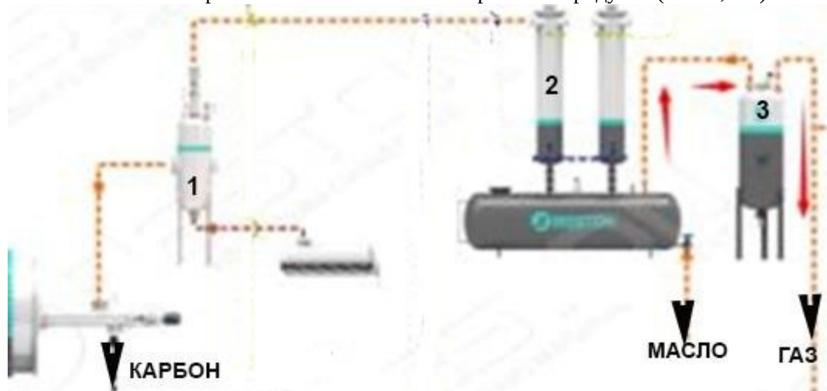
Фиг. № 1.4.2.9. Пречиствателна система за пиролизни продукти (масло, газ)
