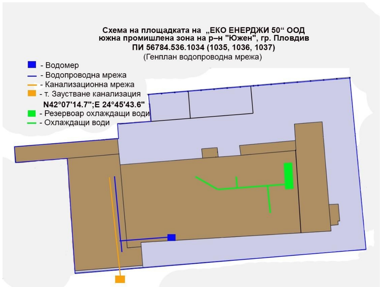
Фигура № 4.3.1.1. Генплан на водопроводната и канализационната мрежа
