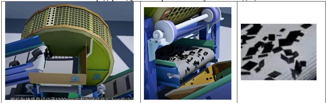
Фиг. № 1.4.2.5. Шредер за дребно нарязване на гумени отпадъци от ИУАГ
